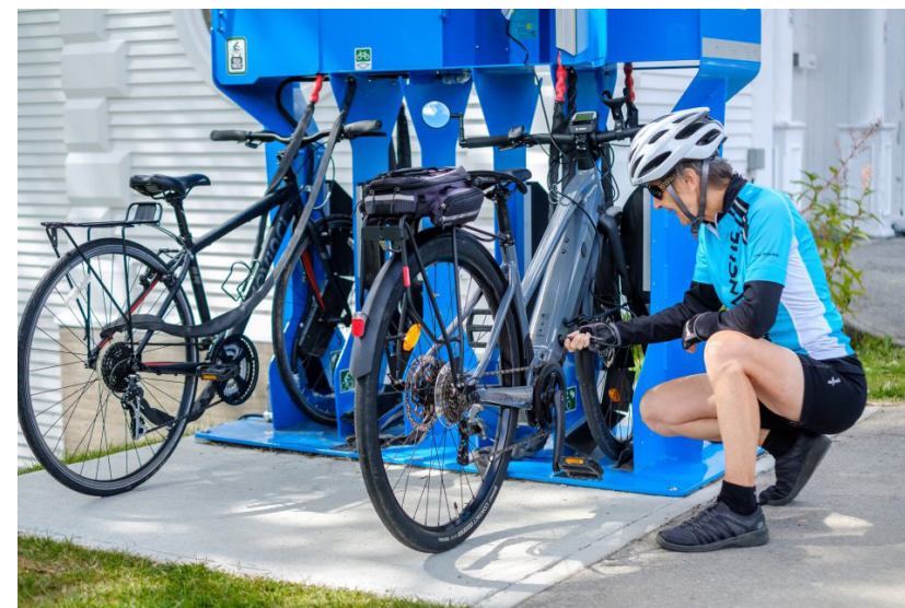
Borne de recharge pour vélo électrique
